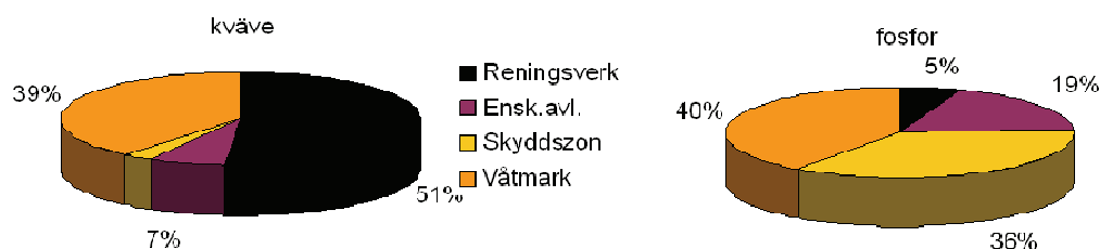
Figur 18. Källfördelningen av reduktionen i åtgärds paket 1 för a) kväve och b) fosfor. Den totala reduktionen är 19 830 ton kväve/år, 2 700 ton fosfor/år (se tabell 5).
