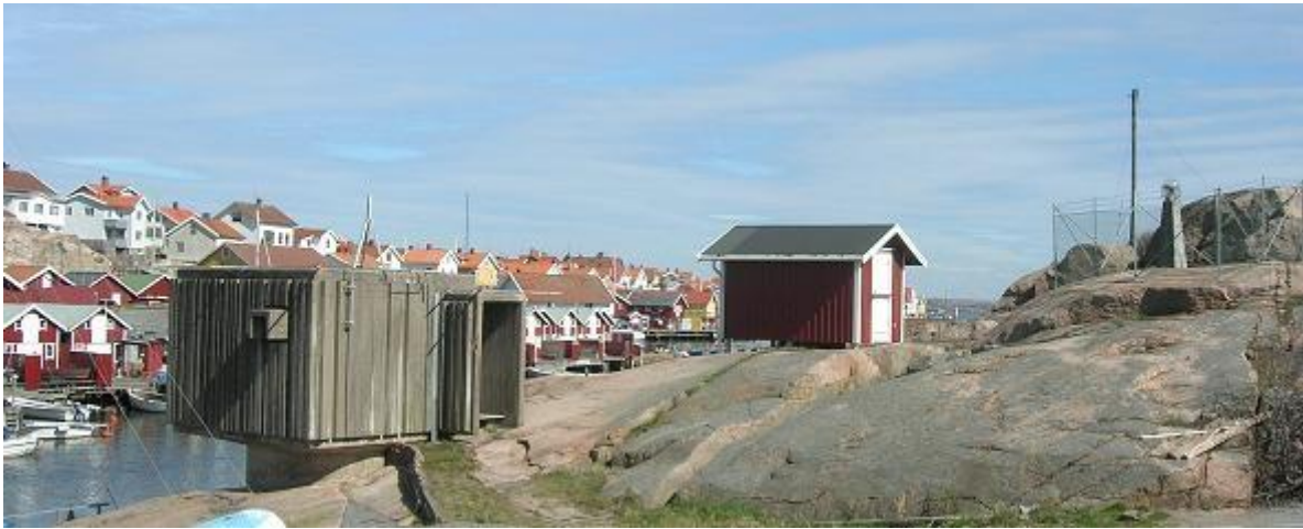
Figur 7-2. Havspegeln i Smögen från 1971 (betongbyggnaden till vänster). Pelaren uppe till höger är Lantmäteriets GPS-station för mätning av absolut landhöjning. Samlokalisering av mätningar av havsvattenstånd och absolut landhöjning gör att den globala havsnivåhöjningen kan följas. Foto: Thomas Hammarklint, SMHI.
