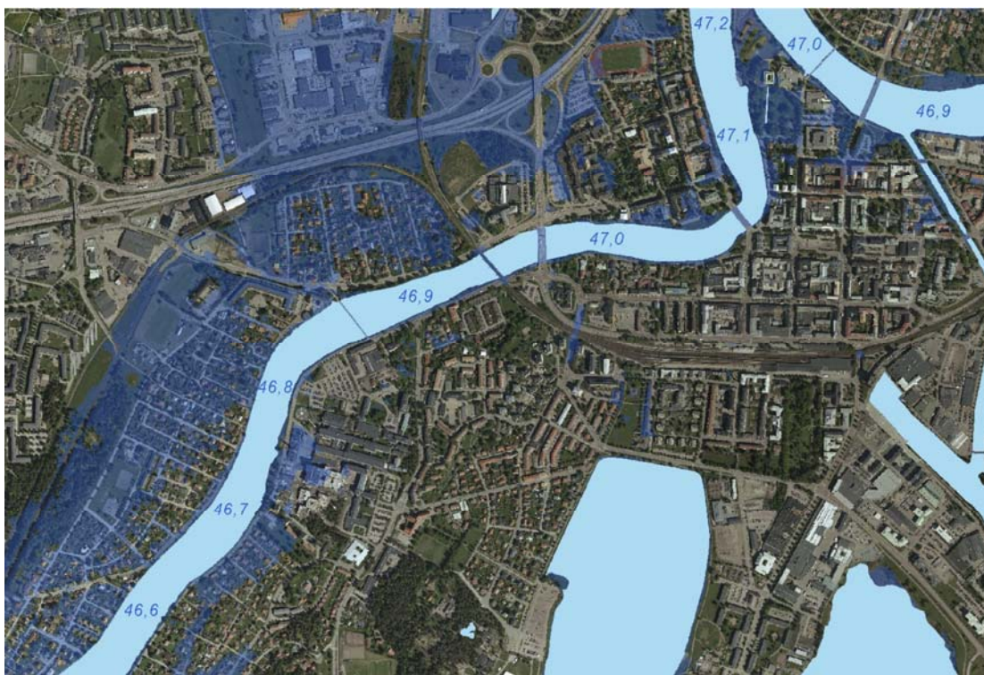
Figur 5: Exempel på karta som visar vattnets utbredning och vattennivå vid 200-årsflöde i Klarälven längs en sträcka av den västra älvgrenen (Vänern på normal nivå). Upphov Karlstad kommun.
