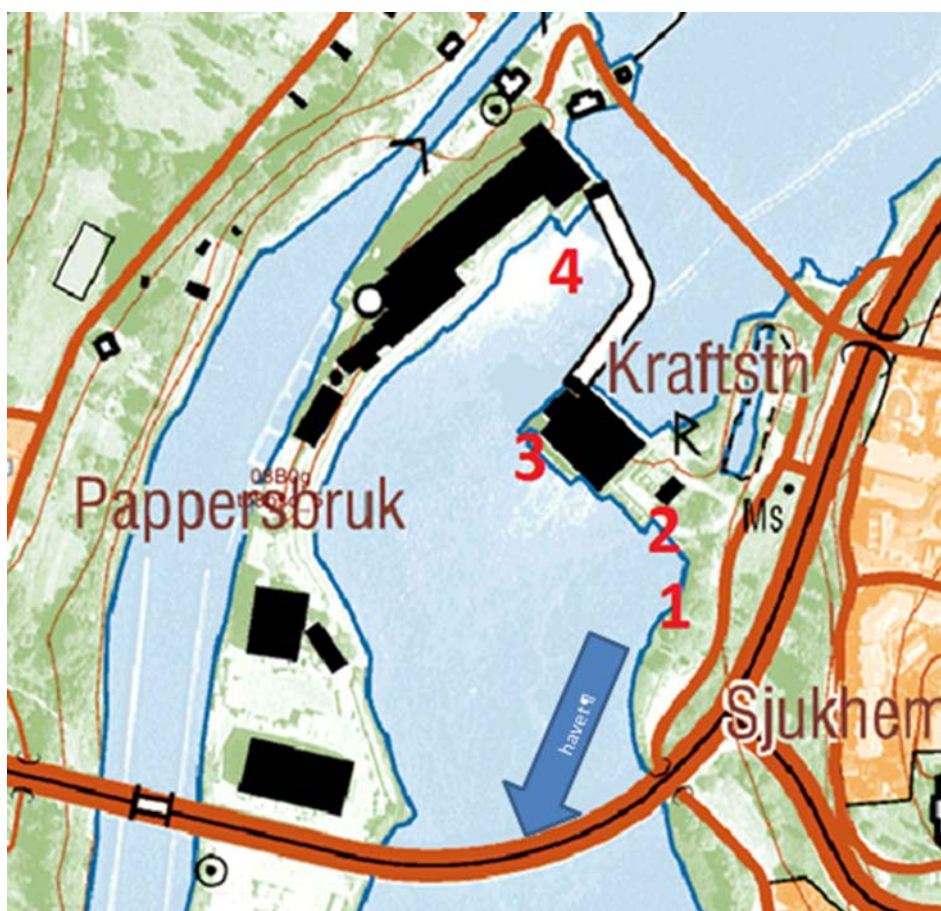
Figur 2. Placering av ålledare/ålsamlare vid kraftverksanläggningen
