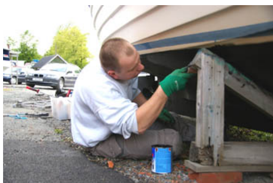
Bild 20: Manuell rengjøring av båtbottem
