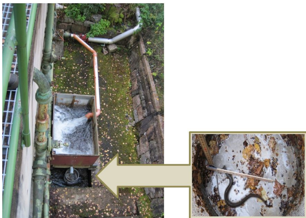
Figur 16. Tömning av samlingsbassängerna ner i såll och hink sett ovanifrån stående på en av bassängerna (foto sept. 2013, sista ålen för året).
