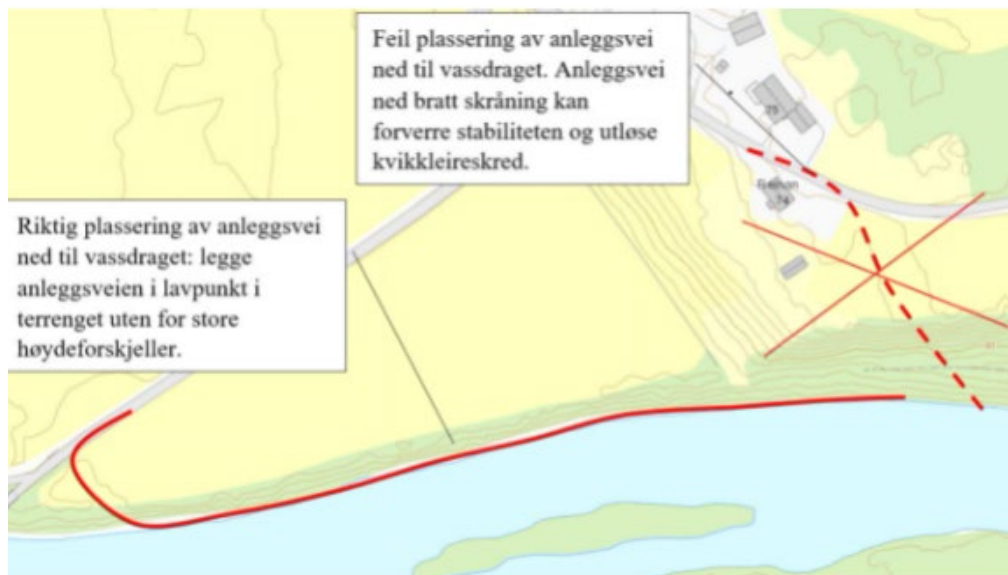
Figur 9: Eksempel som viser bra og dålig plassering for å anlegge en byggveg nær til ålvstranden.
