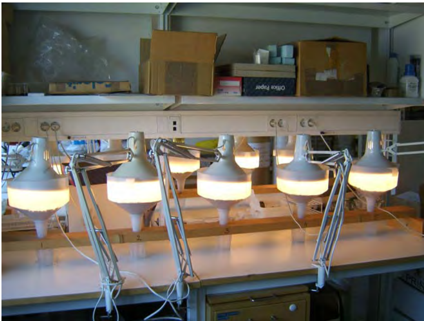
Fig. 1. Tullgrentrattar med belysning och uppsamlingsburkar.
