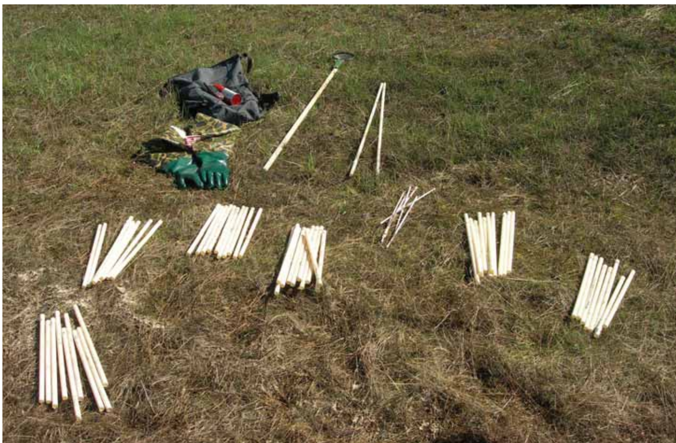
Figur 7: Utrustningen som användes för att följa romutvecklingen på en lekplats. VP-rören var individuellt numrerade och stacks delvis ned i botten vid var romsträng.
