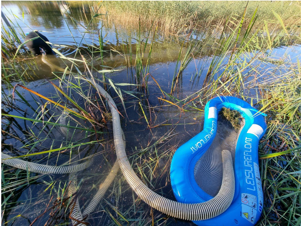
Figur 5. Utloppsroret placerat i "hängmattan" där växtmaterialet samlas upp. I förgrunden syns en person som lossar växterna och matar in i munstycket.
