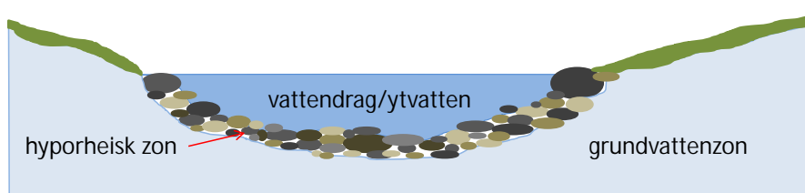
Figur 16. Tvärsnittprofil genom ett vattendrag som ger en schematisk bild över gränzonen mellan ytvattnet och grundvattnet – den hyporheiska zonen. Vattnet i den hyporheiska zonen består antingen av ytvatten som tränger mer i bottenstratet eller av grundvatten som tränger upp mot det ytliga vattnet – eller, som ofta, av en blandning av yt- och grundvatten. Den hyporheiska zonen är ofta en avgörande viktig livsmiljö i vattendraget.
