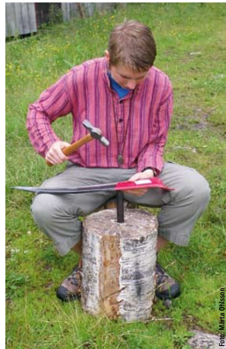
Med hjälp av hammare och städ får man fram en tunn och vass egg på "knacklien".
