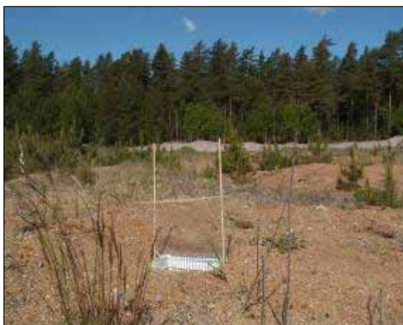
Figur 1. Två av de nyttjade fångstanordningar i samband med inventeringar av bin i de västmanländska grustäkterna. Till fällorna användes propylenglykol. En s.k. gulskål (överst) tillverkad av engångskaffemugg (7cm i diameter) spraymålad med gul UV-färg på insidan och svart på utsidan. Skålen är nedsänkt så att endast ca 2cm sticker upp och med sten som tyngd i botten. Den nedre bilden visar en fallfönsterfälla gjord av engångsform i aluminium, två blompinnar i trä, plastfönster med tak (polystyren, 25*17 cm) och trädgårdssnöre.
