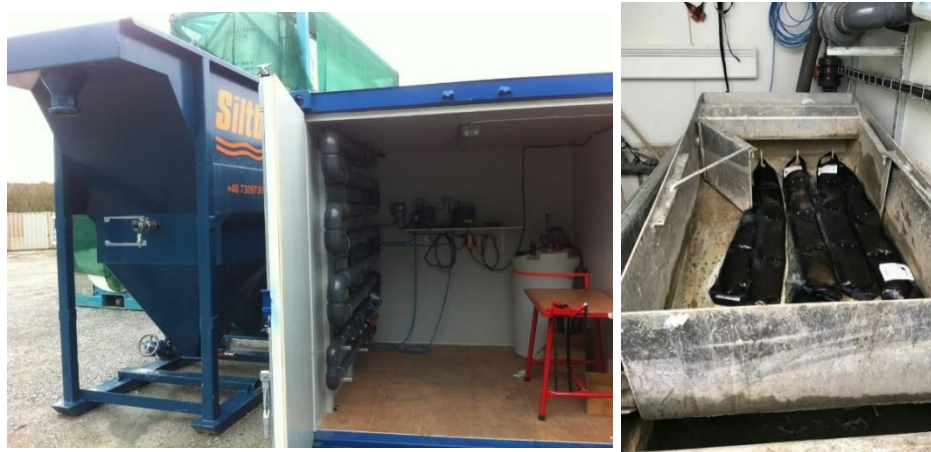
Figur 3.5. Lamellcontainer med flockningstillsatser i container till vänster och flockning med tillsats av kitosan till höger. Foto. A-C. S. Lember
