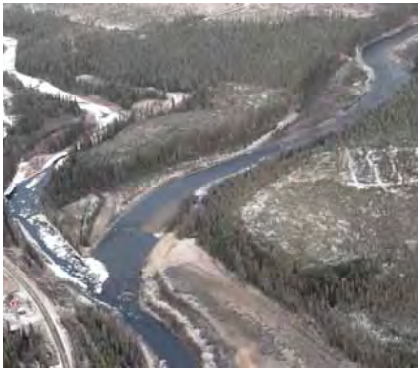
Figur 40. Flygbild från 2007-11-15 över sammanflödet mellan Klarälvens torråra (till höger) och Höljan (till vänster) under en tappning på 9,2 \text{ m}^3/\text{s} från dammen. Bilden visar en omfattande isbildning i Höljan medan torråran är isfri. Foto: Jan Tomperi.
