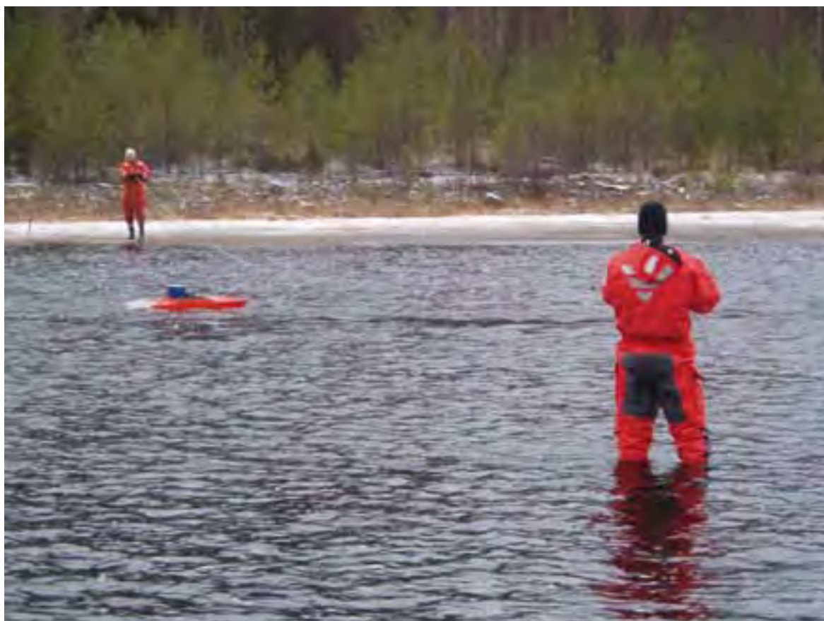
Figur 2. Flödesmätning med ADCP vid lokal W10.
