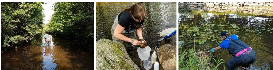
Figur 1. Provtagningsmetoden för kiselalger innebär i korthet att minst fem stenar borstas av med en ren tandborste och påväxtmaterialet sköljs ner i en behållare. Stenarna insamlas längs en provtagningssträcka som är representativ för lokalen med avseende på bottensubstrat, vegetation, vattendjup, vattenhastighet och beskuggning. Om det är för djupt för att vada eller om det inte finns stenar tas prov från vattenväxter. Proven fixeras med etanol.
