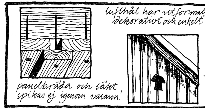
lockpanel den äldsta och enklaste typen locklistpanel ohyvlad för Falu rödfärg locklistpanel hyvlad, profilerad för oljefärg
