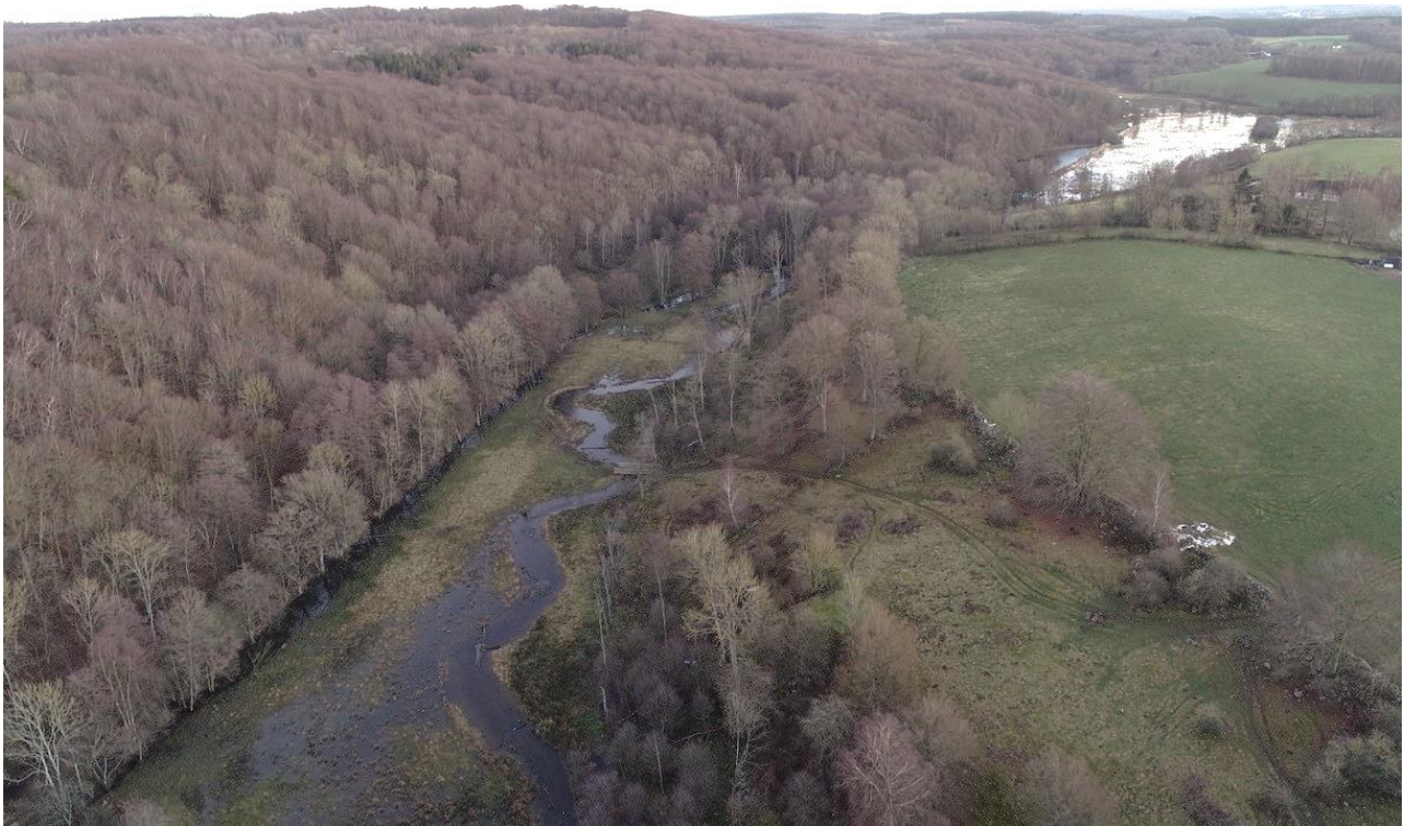
Bild: Exempel på återmeandrad sträcka vid Bauseröd i Hallabäcken, Vege å. En meandrande fåra har återställts och det tidigare rätad diket (längsmed trädriddån till väster) har lagts igen.
