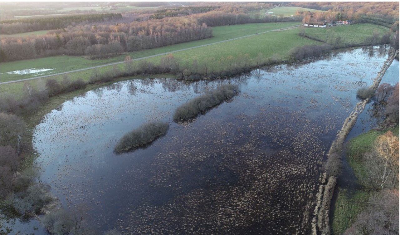
Bild: Exempel på återställt svämplan vid Bauseröd i Hallabäcken, Vege å. En meandrande fåra har återställts och det tidigare rätad diket (till höger) har lagts igen.
