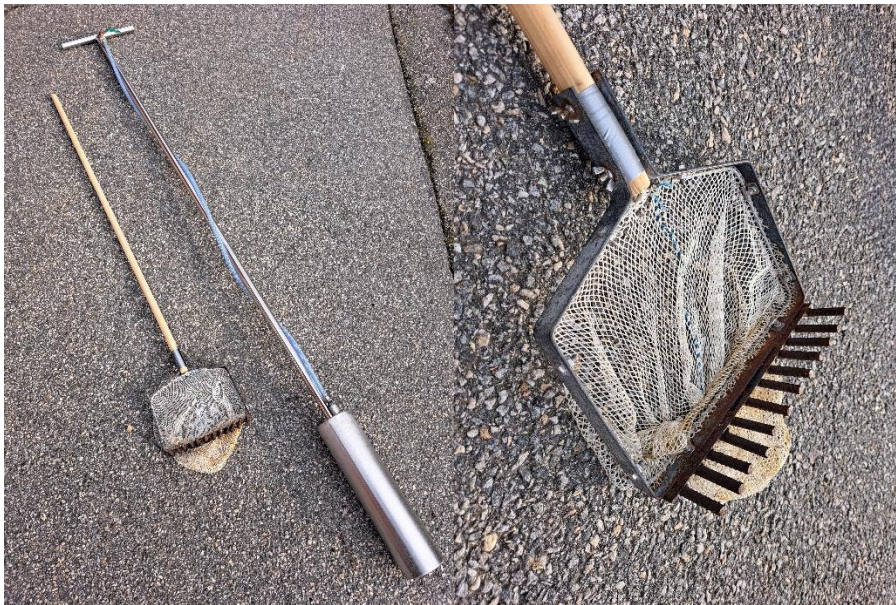
Figur 1. Utrustning som användes för att samla in musslor i detta projekt. Krattan hade kraftiga metallpigggar och ett nät fäst vid krattan för att samla in organismer som lever i botten. Liknande redskap används av musselfiskare i andra länder. Metallstången (bild till vänster) användes för att ta bottenprover i djupare vatten (>1,5 m). Bilder: Youk Greeve.
