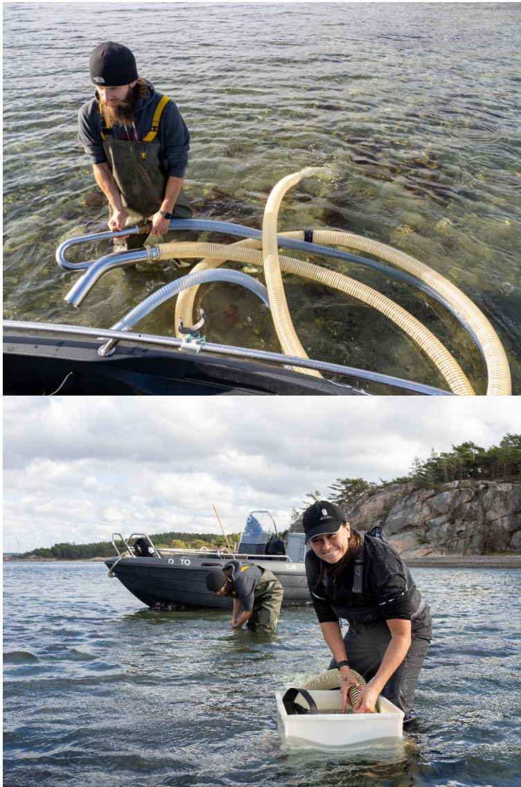
Figur 3: Bilder från fältarbetet vid bottenrengöringsförsöket med vakuumsug vid Lyngnholmssundet som visar slangarna som används för att suga upp sedimentet (överst) och siktarna som används för att samla upp det (nederst). Bilder: Mikael Andersson.
