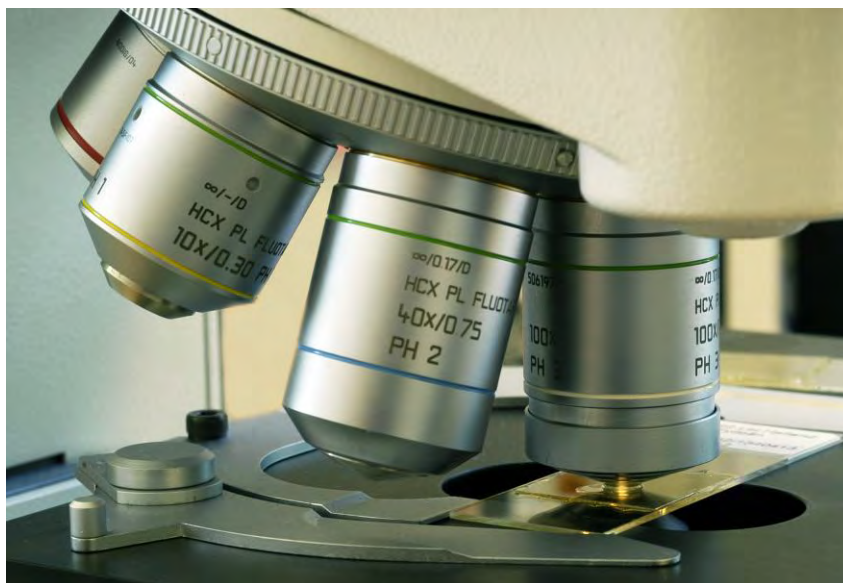
Figur 2. Kiselalgsanalys görs i ljusmikroskop i minst 1000 gångers förstoring med oljeimmersionsobjektiv. Mikroskopet ska helst vara utrustat med interferenskontrast, vilket gör att man kan se mycket små former tydligare än med andra tekniker, © Medins Biologi AB.
