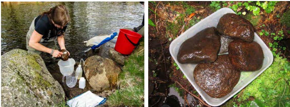
Figur 1. Stenar borstas av med en ren tandborste och påväxtmaterialet sköljs av med vatten ner i en behållare.
