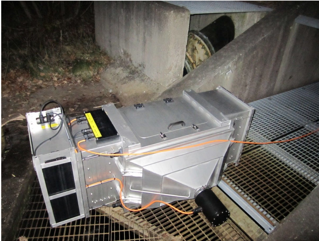
Figur 7. Vaki RW fiskräknare med fototunnel och skannerenhet.
