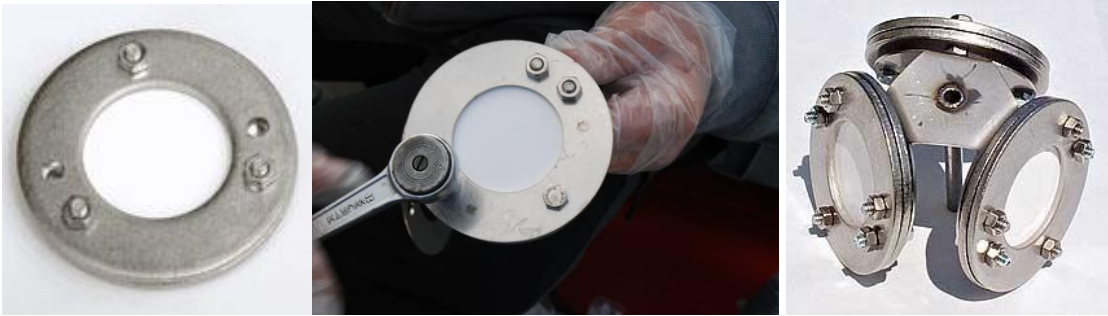
Figur E. POCIS-membran före, under och efter montering på en POCIS-bärare.
