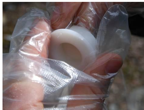
Figur G. DGT-provtagarens uppbyggnad och fiskelinan fästs i ett hål i provtagarens kant.
