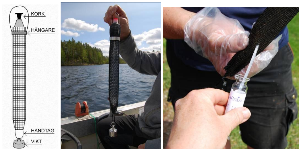
Figur F. PDB-provtagare och tömning av prov i en headspace-vial.
