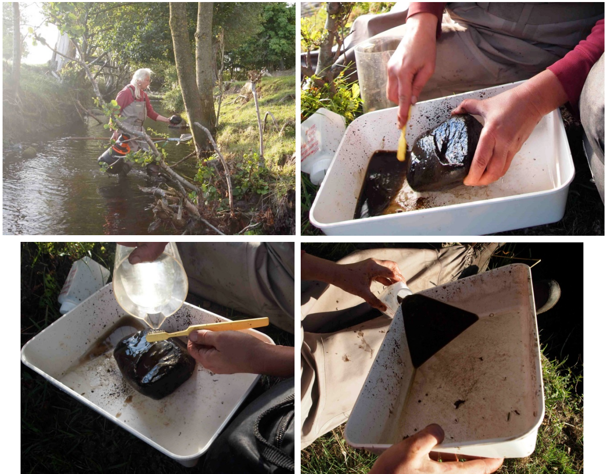
Figur 2. Vid kiselalgsprovtagningen hämtas minst fem slumpvis valda stenar från en representativ sträcka av vattendraget (överst t.v.). Därefter borstas kiselalger och övrig påväxt av från stenarna med en ren tandborste (överst t.h.). Materialet sköljs av och samlas upp i en vanna (underst t.v.). När alla stenar borstats blandas materialet i vannan nogga och hälls i burkar (underst t.h.). Efter att materialet har sedimenterat i burken hälls större delen av vätskan av och ersätts med etanol (foton: Linn Svensson Renström, Länsstyrelsen Skåne).
