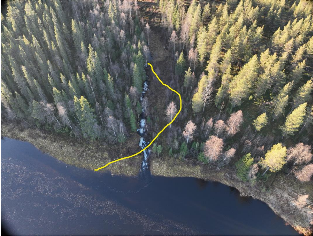
Figur 18. Flygbild över åtgärdssträckan i Myllyoja. Gul linje är förslag på ny dragning av vattendraget.
