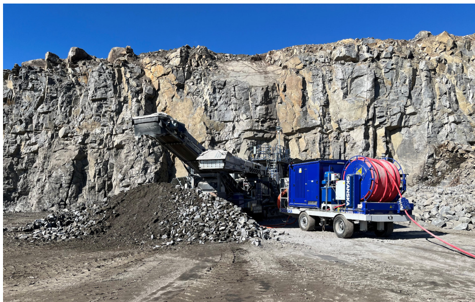
Figur 7.1. Skanska har utvecklat en eldriven stenkross som har fått stöd från Klimatklivet.
