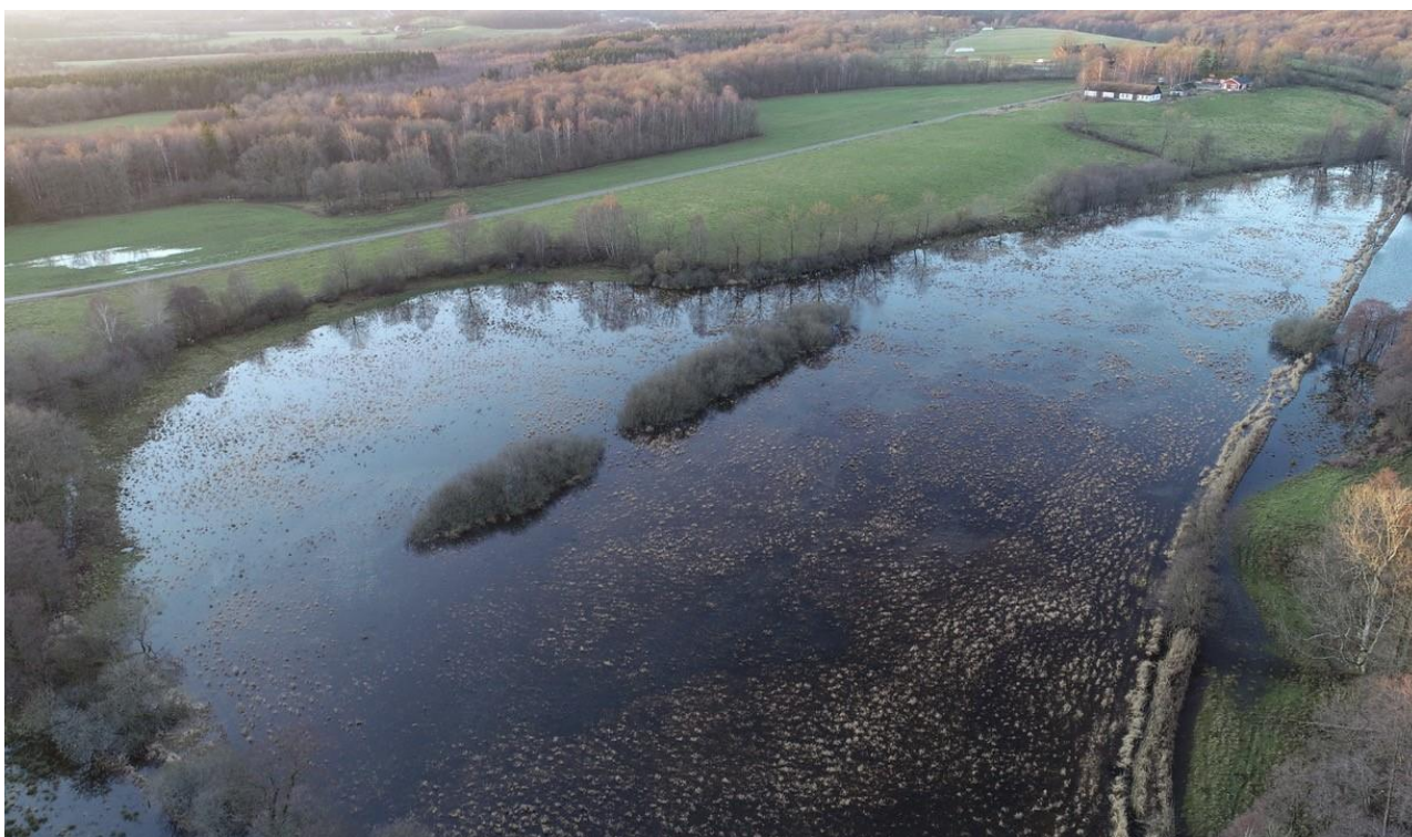
Bild: Exempel på återställt svämplan vid Bauseröd i Hallabäcken, Vege å. En meandrande fåra har återställts och det tidigare rätad diket (till höger) har lagts igen.
