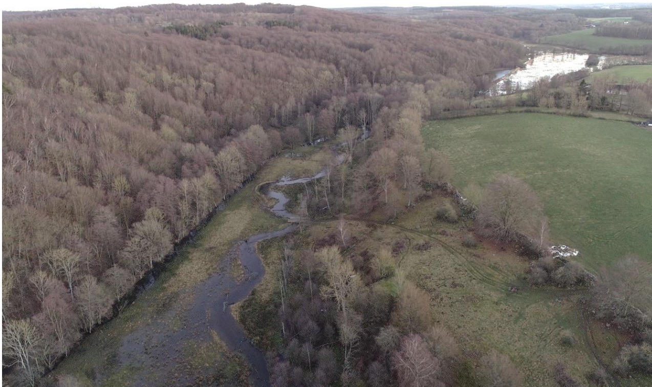
Bild: Exempel på återmeandrad sträcka vid Bauseröd i Hallabäcken, Vege å. En meandrande fåra har återställts och det tidigare rätad diket (längsmed trädriddån till väster) har lagts igen.
