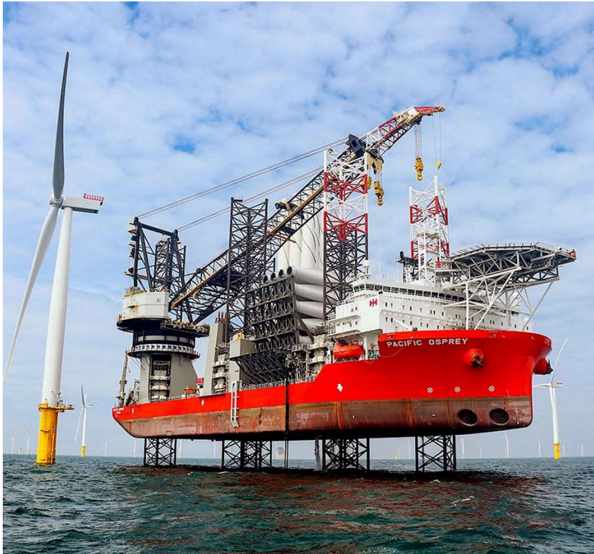
Figur 2.2-Upphissat fartyg (Wind Turbine Installation Vessel, WTIV) med ben som sträcker sig ned till havsbotten och som fartyget hissas upp från
