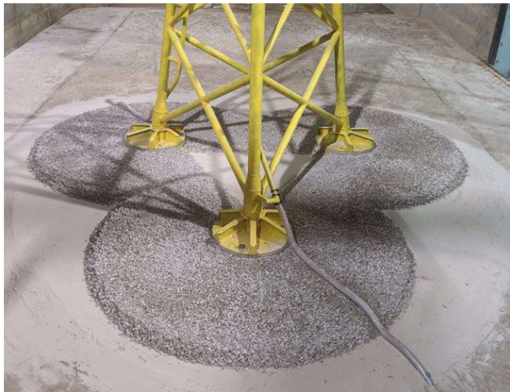
Figur 3.5- Exempel på sten som erosionsskydd runt ett fackverksfundament
