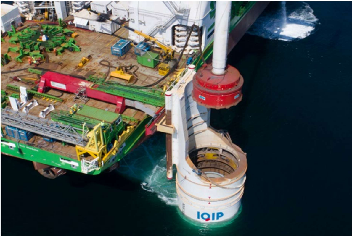
Figur 3.3-Illustration av IHC-NMS system
