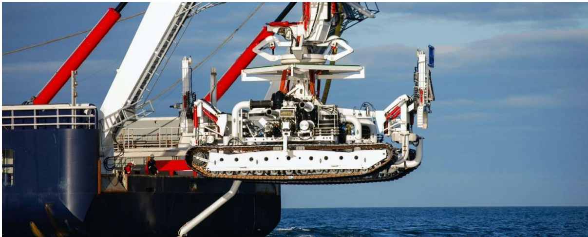
Figur 5.8-Exempel av fjärrstyrd farkost med mekaniskt skärverktyg
