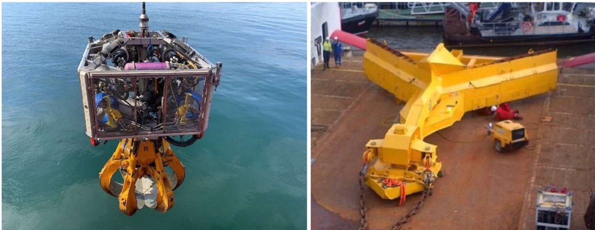
Figur 5.4-Exempel på gripklo för stenblock (till vänster) och plog (till höger)
