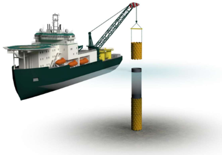
Figur 3.8- Beklädning av monopile
