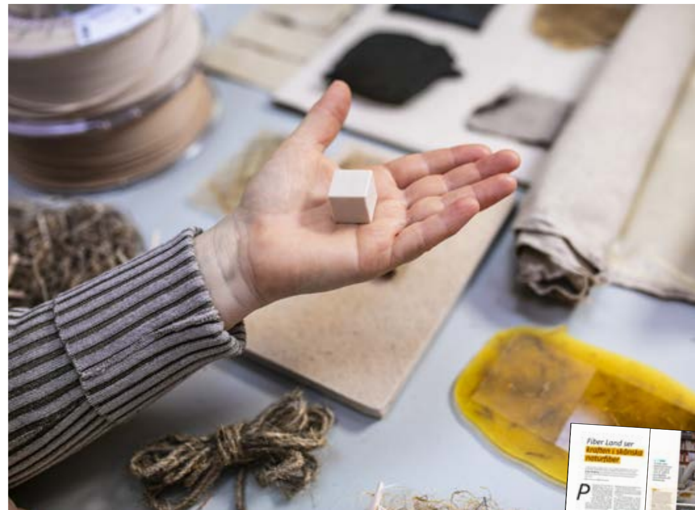
Jenny håller en bit 3D-printad filament i sin hand. När linfibrer blandas in görs filamentet starkare och kan ersätta plast.
