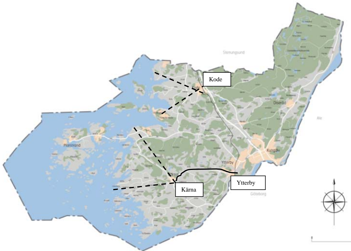
Bild 2. Heldragen linje visar tryckavloppsledningen mellan Kärna och Ytterby (etapp 1). De streckade linjerna visar planerad kommunal VA-utbyggnad enligt VA i kustzon.
