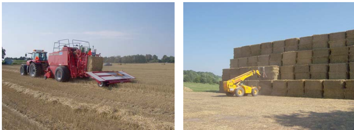
Figur 8. Pressning av bränslehalm till fyrkantbalar (t v) och hantering vid utomhuslager (t h) vid ett halmeldat värmeverk i Svalöv (Foto: Sven Bernesson, SLU).
