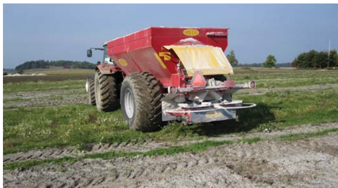
Bild 6. Strukturalken sprids med centrifugalspridare. Bild 7. Och inblandas kraftfullt och djupt i matjorden Foto: Karin Brink
