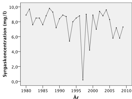
Figur 3. Syretillstånd i Roxen, 1980-2010, utifrån lägsta årliga syrehalt (mg/l). Lägre koncentration än 5 mg O 2 /l bedöms som svagt syretillstånd. Sjön har hög status gällande syrehalt enligt Naturvårdsverkets nya bedömningsgrunder.
