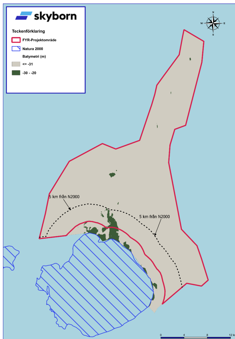
Figur 1. Områden med djup grundare än 30 m inom ett avstånd av 5 km från gränsen till Natura 2000-området Finngrundet-Östra banken. Vindkraftparken har ett avstånd om minst 2 km till närmaste Natura 2000-område.
