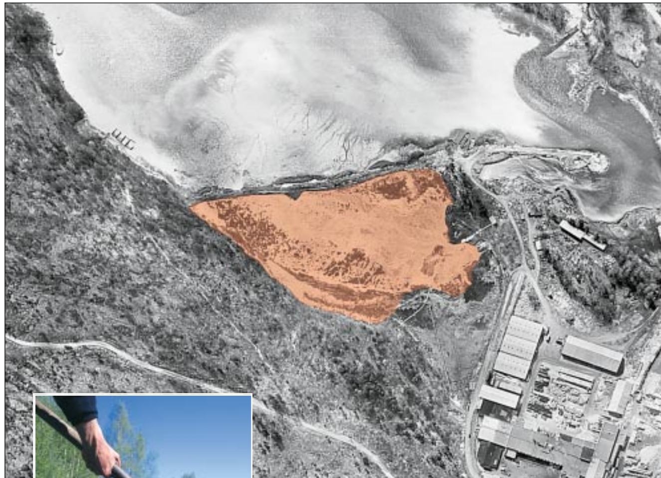
Flygfoto över Westerviks Pappersbruk med det stora lagret av returpapper till höger. Utanför ses den svårt förorenade viken. Bassängen som skulle fånga upp fibrerna har markerats med brun färg.
