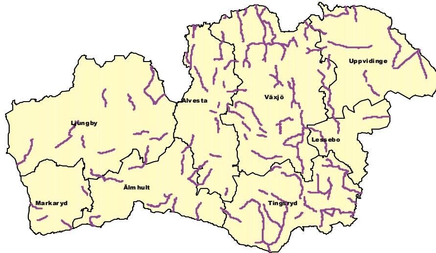
Figur 3: Bärighetsbrister i form av temporära bruttoviktrestriktioner. Källa: Vägverket Region Sydöst.
