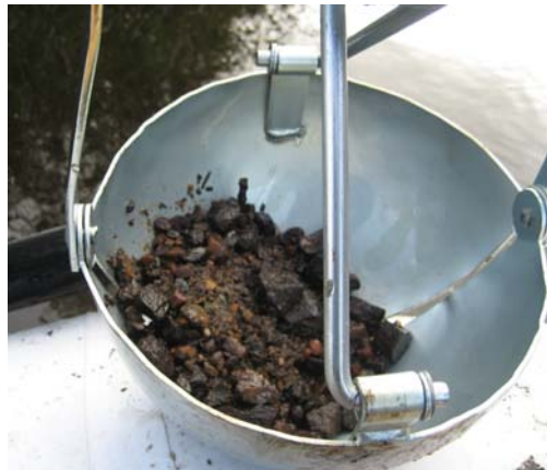
Fig 1. Bild på sedimentprovtagaren med mindre mängd prov. Det aktuella provet är taget i en delsträcka med mycket block och provet representerar materialet mellan blocken.
