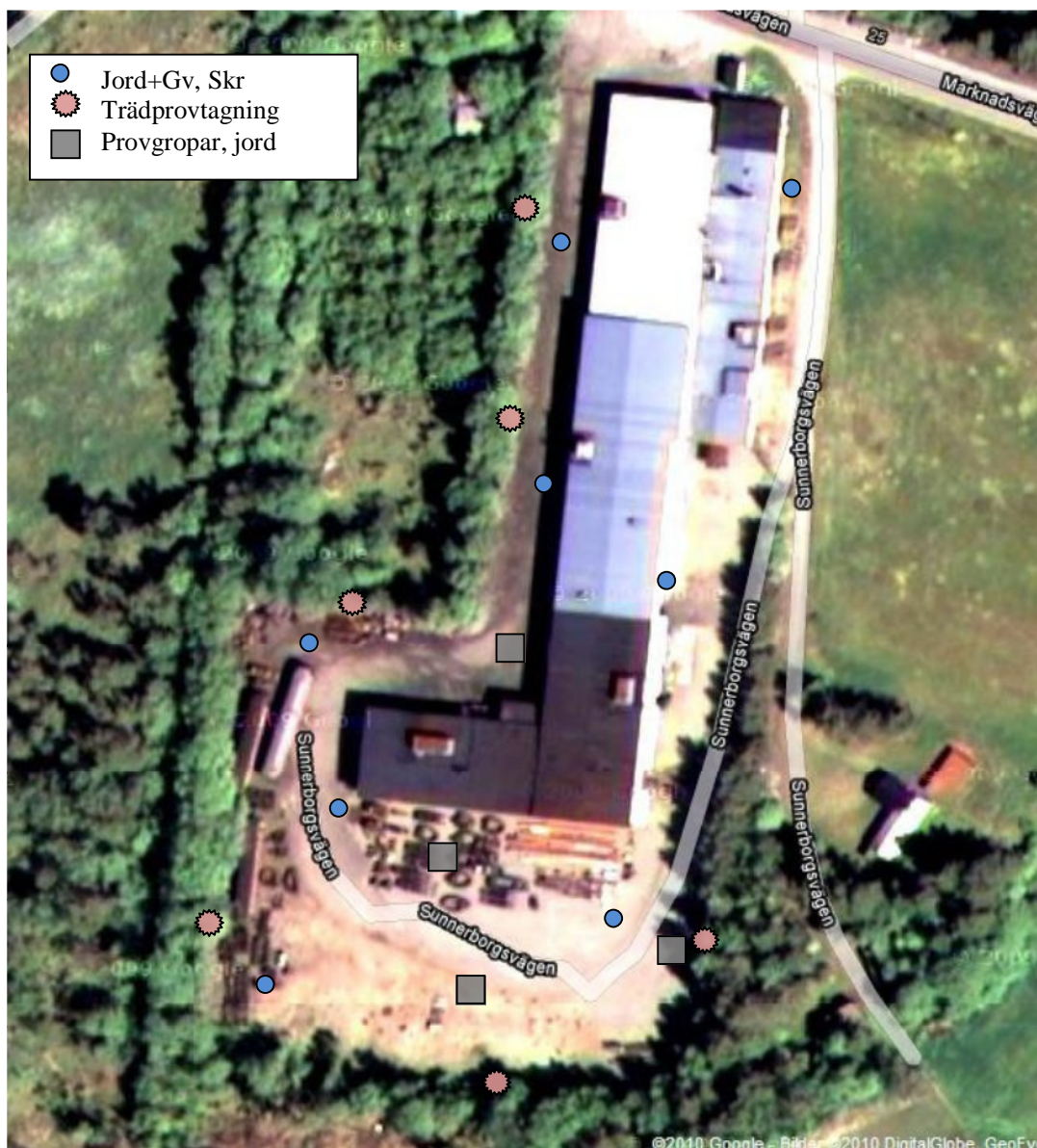
Figur 2. Provtagningsplan för Kågeverken, ungefärliga lägen. Porgasmätning under bottenplattan genomförs med fältinstrument (PID).
