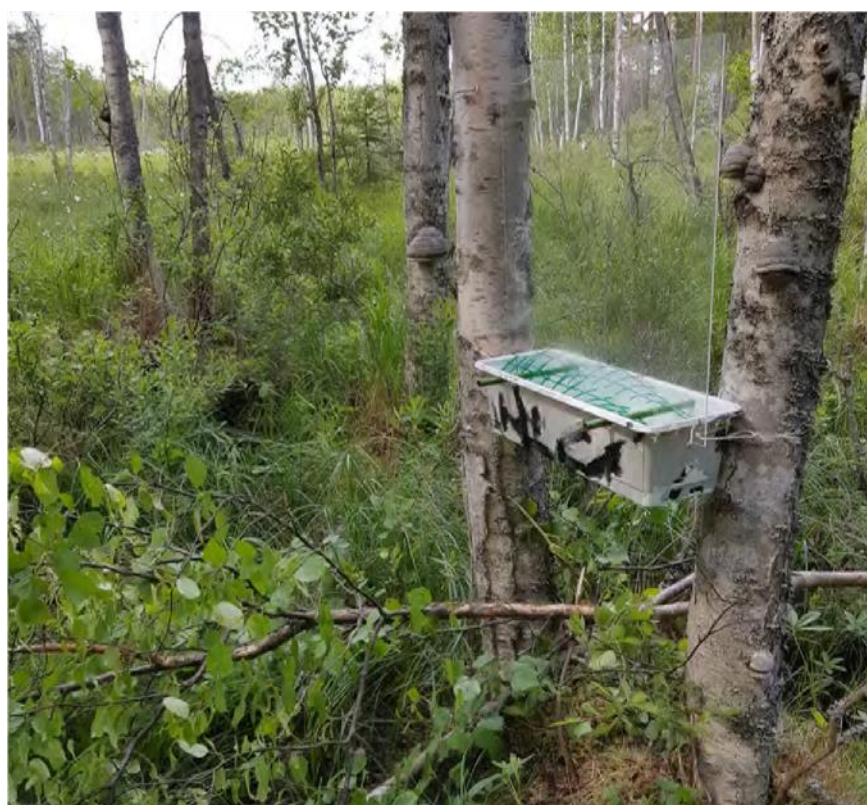
Bild 2. Fotografi från Bockaskröv S som visar en fälla placerad mellan en björk och en björktroraka med anlockningsved under fällan.
