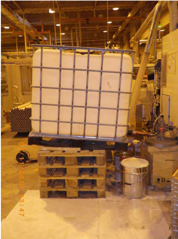
Bild 7: Här har man funnit en finurlig lösning på överpumpning av (i detta fallet lim) till en process, med spill både på golvet, längs tanken och från den överfulla "slaskhinken". Anordningen var dessutom inte särskilt stabil ur arbetsmiljösynpunkt. Med hänsyn taget till att golvet i byggnaden var tätt och att kemikalien i detta fall inte var miljöfarlig (enligt säkerhetsdatablad på behållaren), kom bolaget i fråga undan med en anmärkning.
