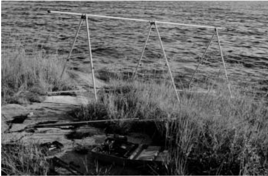
Fig. 13: Genom att fästa kameran mot stativets överliggare kan den förskjutas mellan exponeringarna så att villkoren för den senare fotogrammetriska bearbetningen kan uppfyllas. Kameraaxeln ska vara lodrätt riktad och övertäckningen mellan bilderna ska vara minst 60 procent. Den liggande avvägningsstången utgör referensnivå. Foto: Lars Granath.
