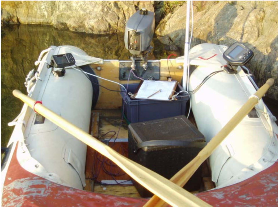
Figur 3-1. Gummibåt utrustad med ekolod och GPS användes för inmätning av transekterna.
