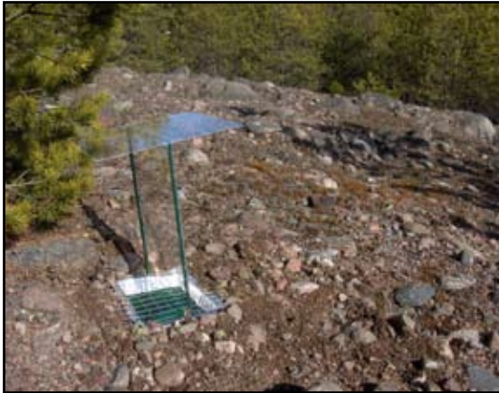
Fig 5. En fönsterfälla består av en genomskinlig plastskiva ovanför en folieform med propylenglykol. När flygande insekter krockar med skivan faller de ned i den konserverande vätskan. Metallnät skyddar fångsten mot fåglar. Fällan tar även marklevande skalbaggar. Här vid Arlanda motorbana där en av fällorna sattes i grov miljö.
