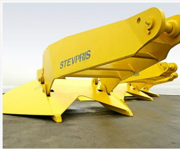
Figur 3-8 Variant av vanligt förekommande dragankare (Bild: Vryhof)
