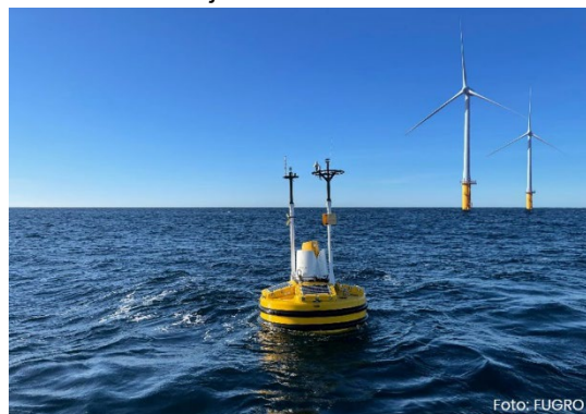
Figur 5-1 Flytande LiDAR. Bild: Fugro Seawatch® Wind Lidar Buoy image © Fugro
