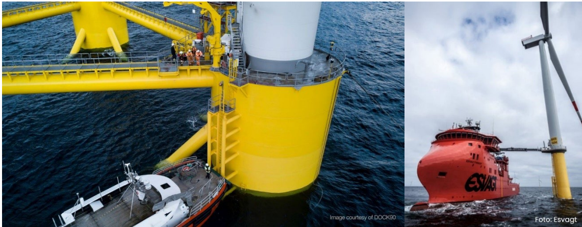
Figur 7-2 Servicepersonal går ombord på plattformen för underhåll i drift – vänster: Personaltransportfartyg, höger: SOV med "walk to work"-system.
