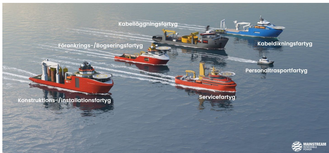
Figur 6-13 Översikt över typiska fartyg som används vid konstruktion av en flytande vindkraftspark.
