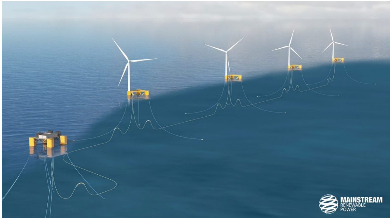
Figur 1-1 Exempel på ett flytande vindkraftssystem (huvudsaklig havsbaserad infrastruktur över och under havsytan).
