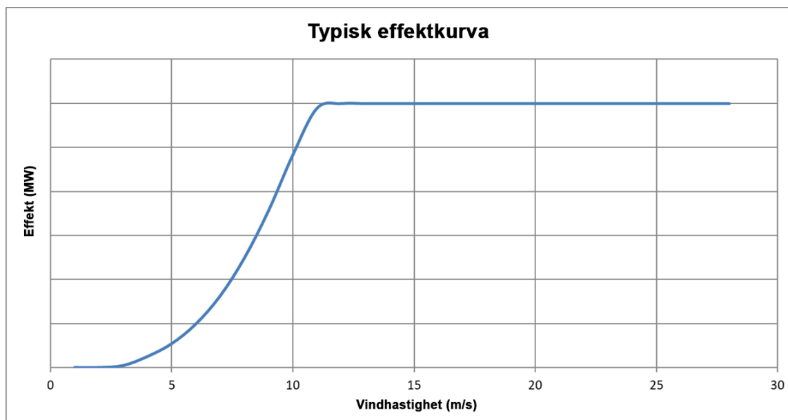
Figur 3-4 Typisk effektkurva för ett vindkraftverk.
