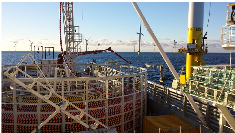
Figur 21. Ett kabellägningsfartyg lägger kablar på havsbotten i en vindkraftspark
