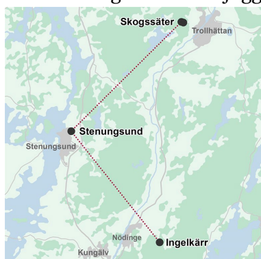
Figur 25. Nätförstärkning via nya 400 kV-ledningar Skogssäter–Stenungsund–Ingelkärr
