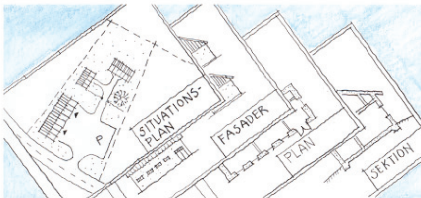
Ritningar för bygglov och byggsamråd kan bestå av situationsplan, fasadritning, planritning och sektion. De ska visa utseendet före och efter ändringen.
