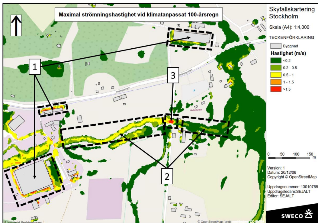
Figur 6. Exempel på resultat för maximal strömningshastighet vid klimatanpassat 100-årsregn. De tre områden som benämns "1" visar höga strömningshastigheter på grund av lokal påverkan från byggnader. Områden som benämns "2" visar väl urskiljbara flödesvägar med större strömningshastighet i mitten av flödesvägen. Området som benämns "3" visar lokal höjning av strömningshastighet då vattnet rinner över vägkrön.
